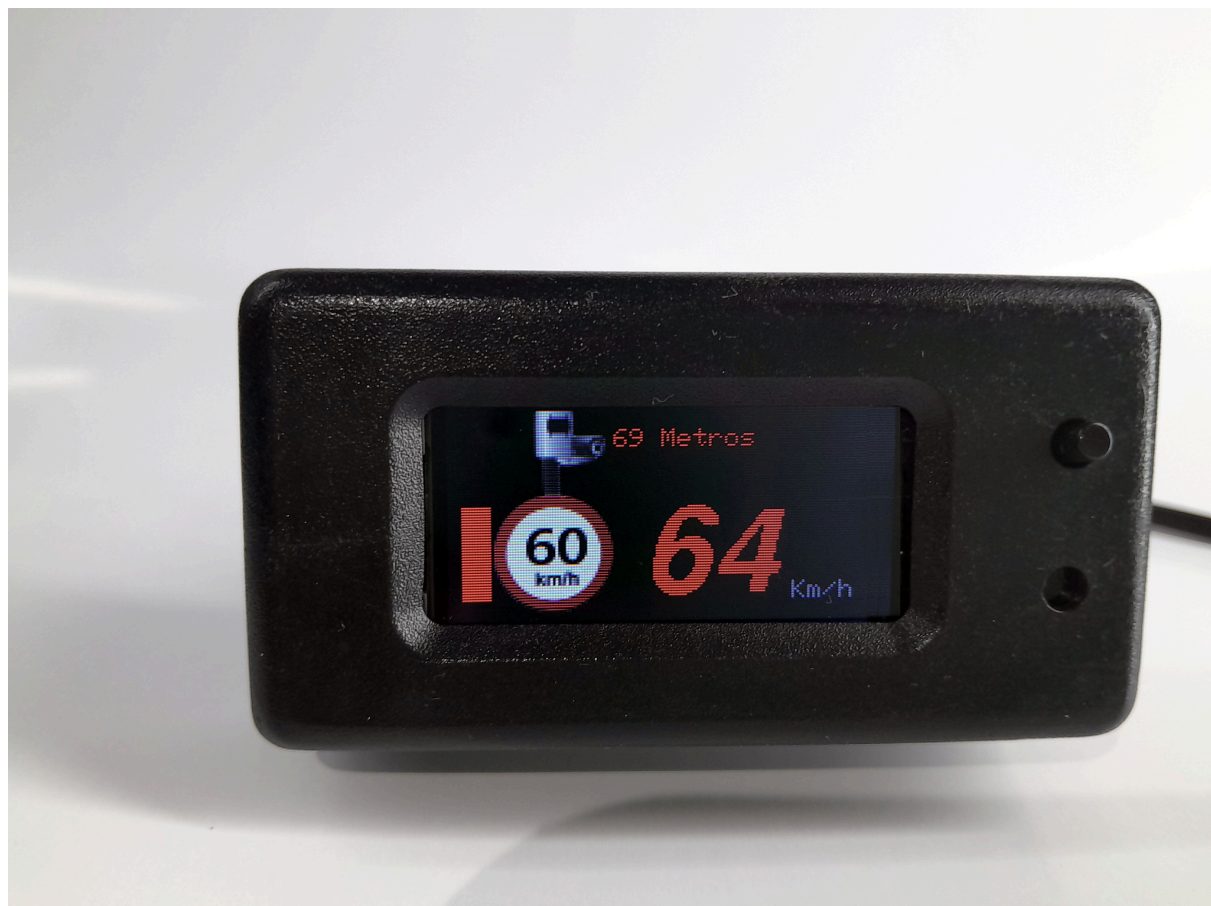
[FIGURA 4 - Exemplo da tela durante um alerta de excesso de velocidade próximo ao radar]
