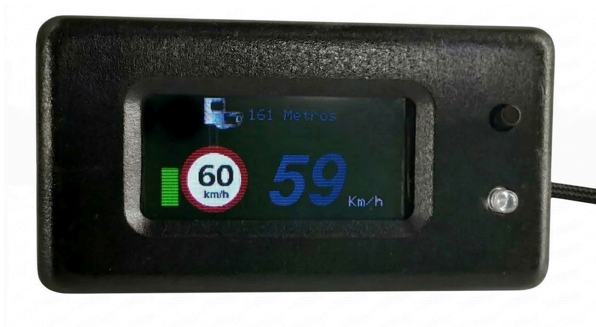
[FIGURA 3 – Exemplo da tela ao detectar um radar estando dentro da velocidade permitida]
